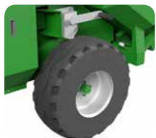
VERSIONE CARELLATA CON KIT RUOTE E TIMONE COMPRESO ATTACCO 3 PUNTI
